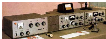
Sl. 6a. Nova "Yaesu" F-linija KT SSB uređaja, L-D: linearni pojačavač FL-1000 (1,5kW); zvučnik SP-100; prijemnik FR-100B i predajnik FL-100B, snage 100W
