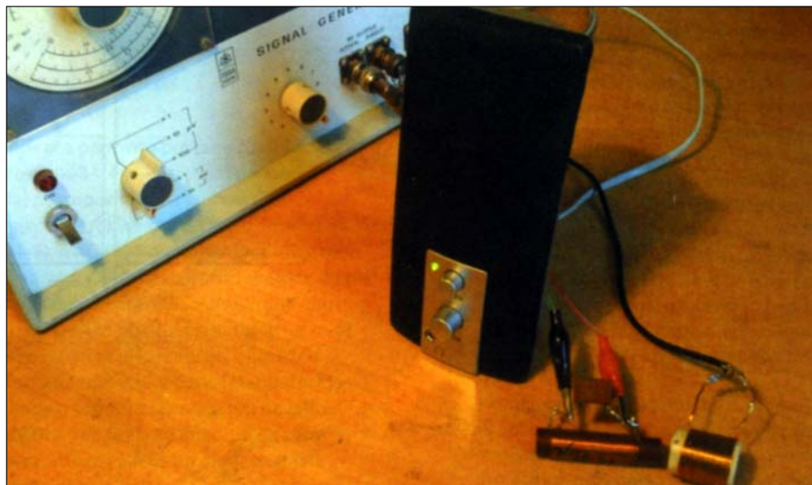
Fotografija celog sklopa. Sasvim desno dole je zavojnica L SG spojena na signal-generator, levo od njeje oscilatorno kolo kome merimo frekvenciju. Spojen je štipaljka na merač u kutiji sa zvučnikom i pojačalom.
